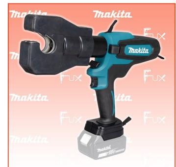
Dank der automatischen Rückzugsfunktion kehrt der Stempel nach jedem Pressvorgang automatisch in seine Ausgangsposition zurück, was einen schnellen Arbeitsablauf ermöglicht. Bei Bedarf kann die automatische Rückzugsfunktion über einen Ein-/Aus-Schalter deaktiviert werden. Das Werkzeug verfügt ausserdem über einen separaten Entriegelungsknopf zum manuellen Zurückziehen des Stempels.
